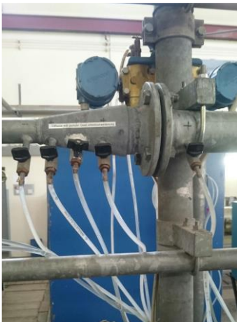
4,5) RohrDiffusor mit un stetiger Querschnittserweiterung
